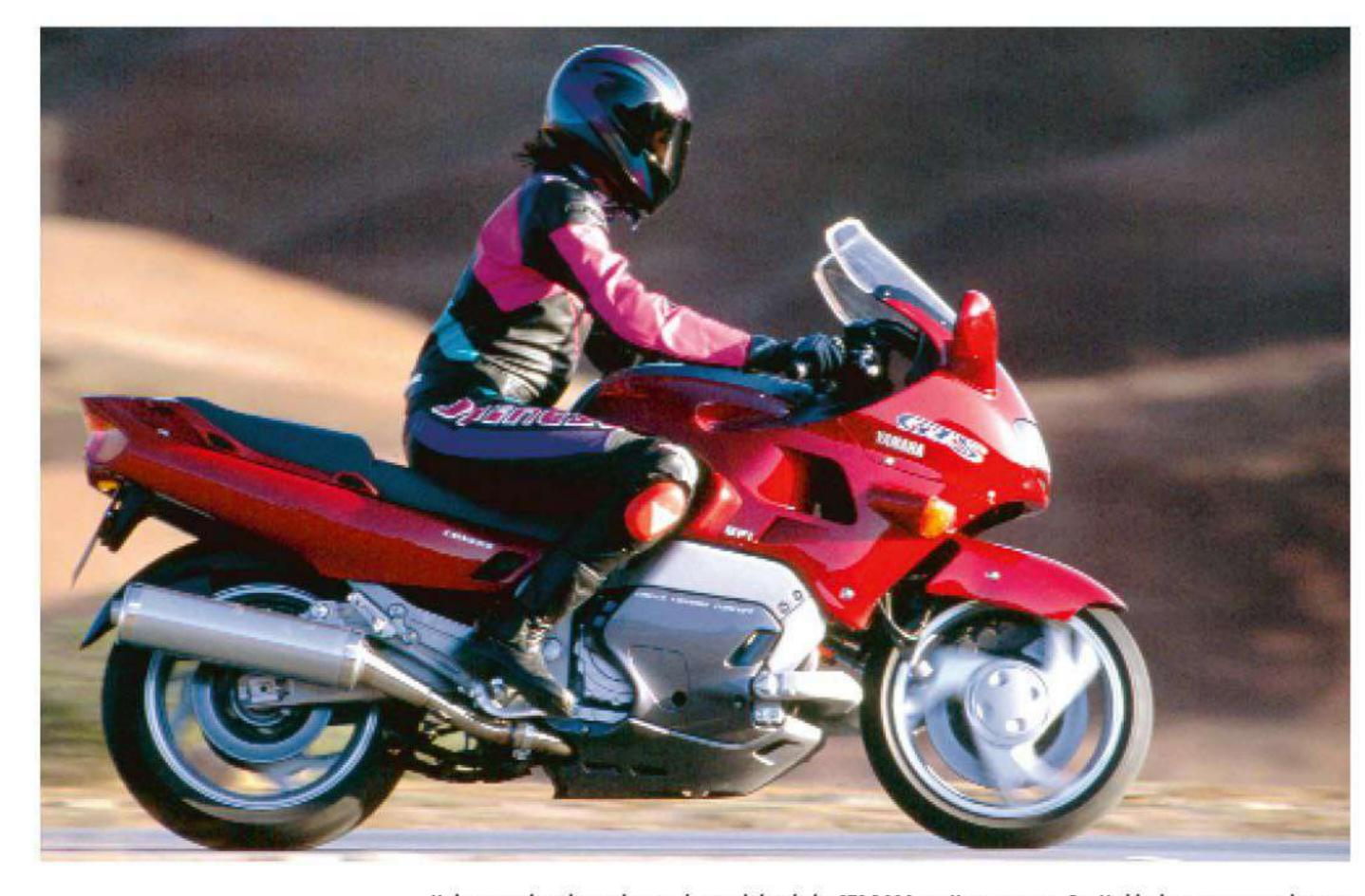
Nicht nur technisch, sondern auch optisch brach die GTS 1000 mit Konventionen. Die Verkleidung war so geschnitten, daß der Omega-Leichtmetallrahmen gut sichtbar blieb. An die klotzig wirkende Achsschenkellenkung mußte man sich gewöhnen. Das Cockpit war reich instrumentiert, die Lenkerstummel paßten zur touristischen Auslegung der Maschine.
